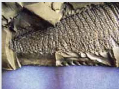
Анализ отслоения протектора шин
