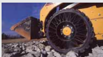
Система «Твил» фирмы «Мишлен» пригодна для подъема по лестнице
