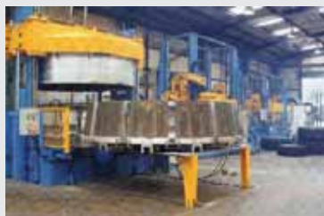
Крупнейший в Европе пресс для вулканизации шин для строительно-дорожных машин
